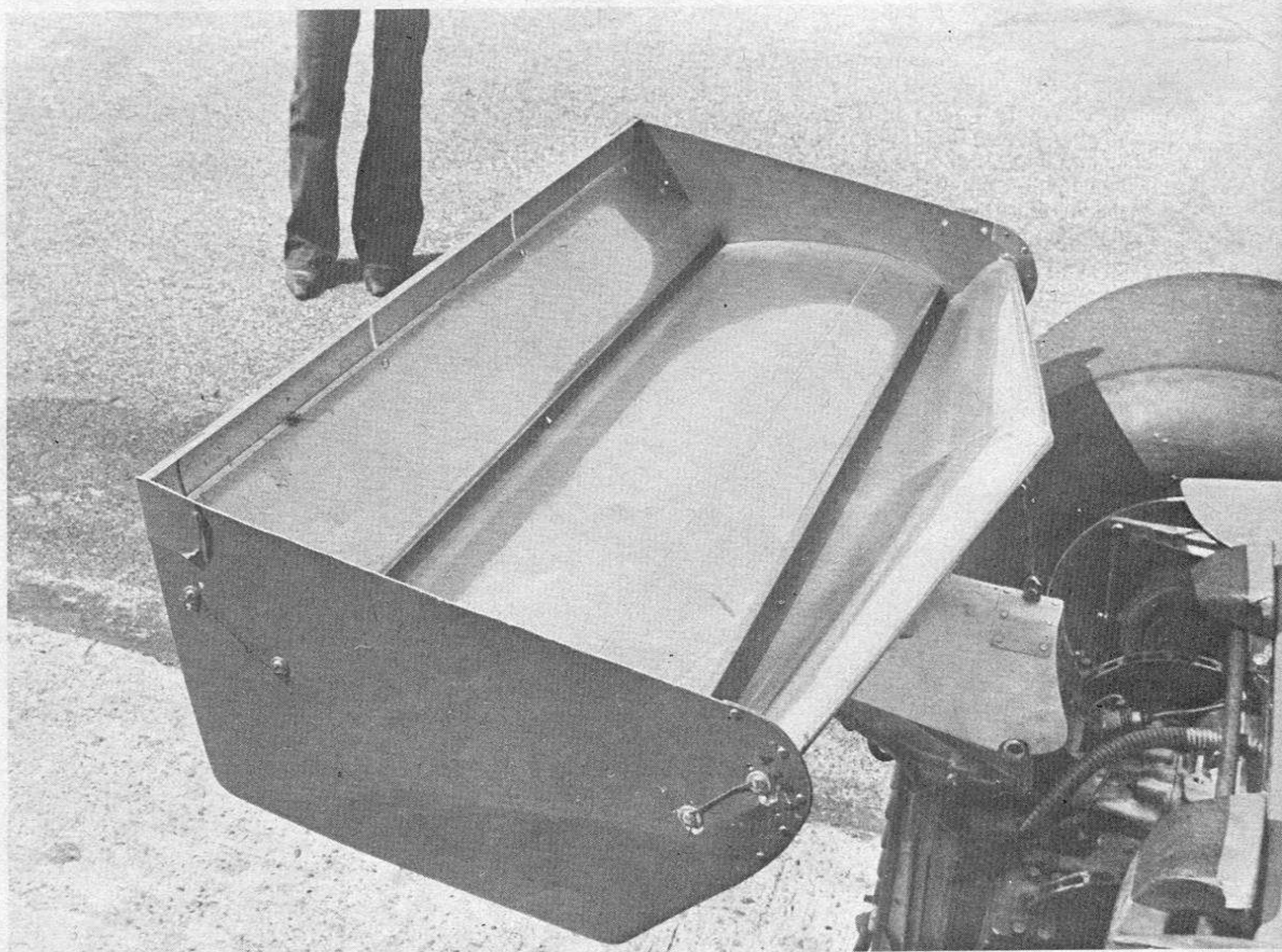
Un alettone del tipo «soffiato», triplano, della Ferrari al GP d'Italia dello scorso anno. Si nota molto bene il bordo d'attacco a «freccia» e le paratie laterali nelle quali la parte centrale dell'ala è stata fissata
