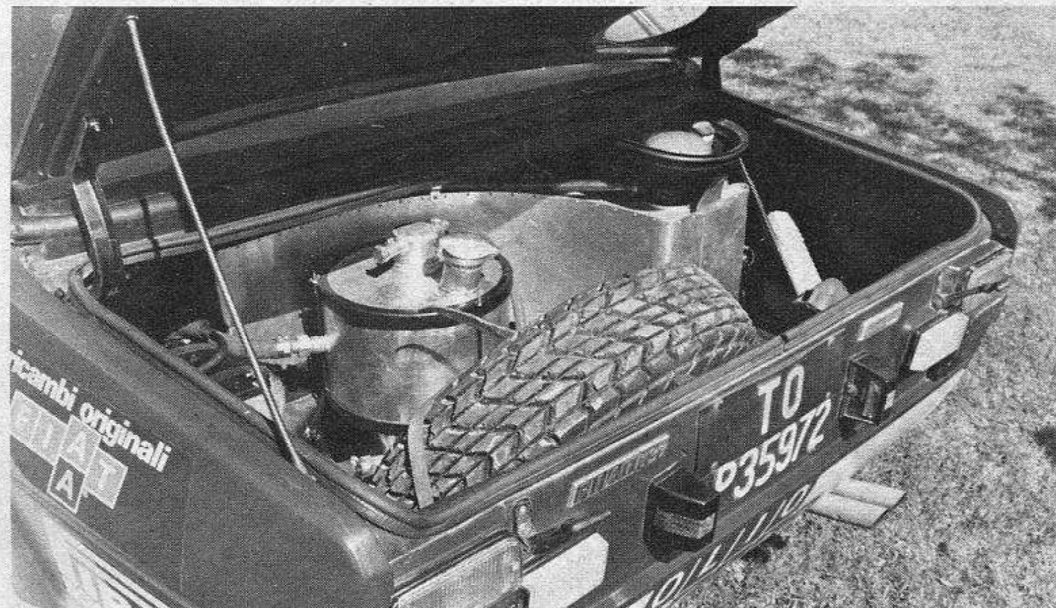
Questo è il bagagliaio della 131 di Rohrl-Geisdorfer. Il serbatoio più piccolo è quello per l'olio del carter secco montato anche sulla 131 di Alen
