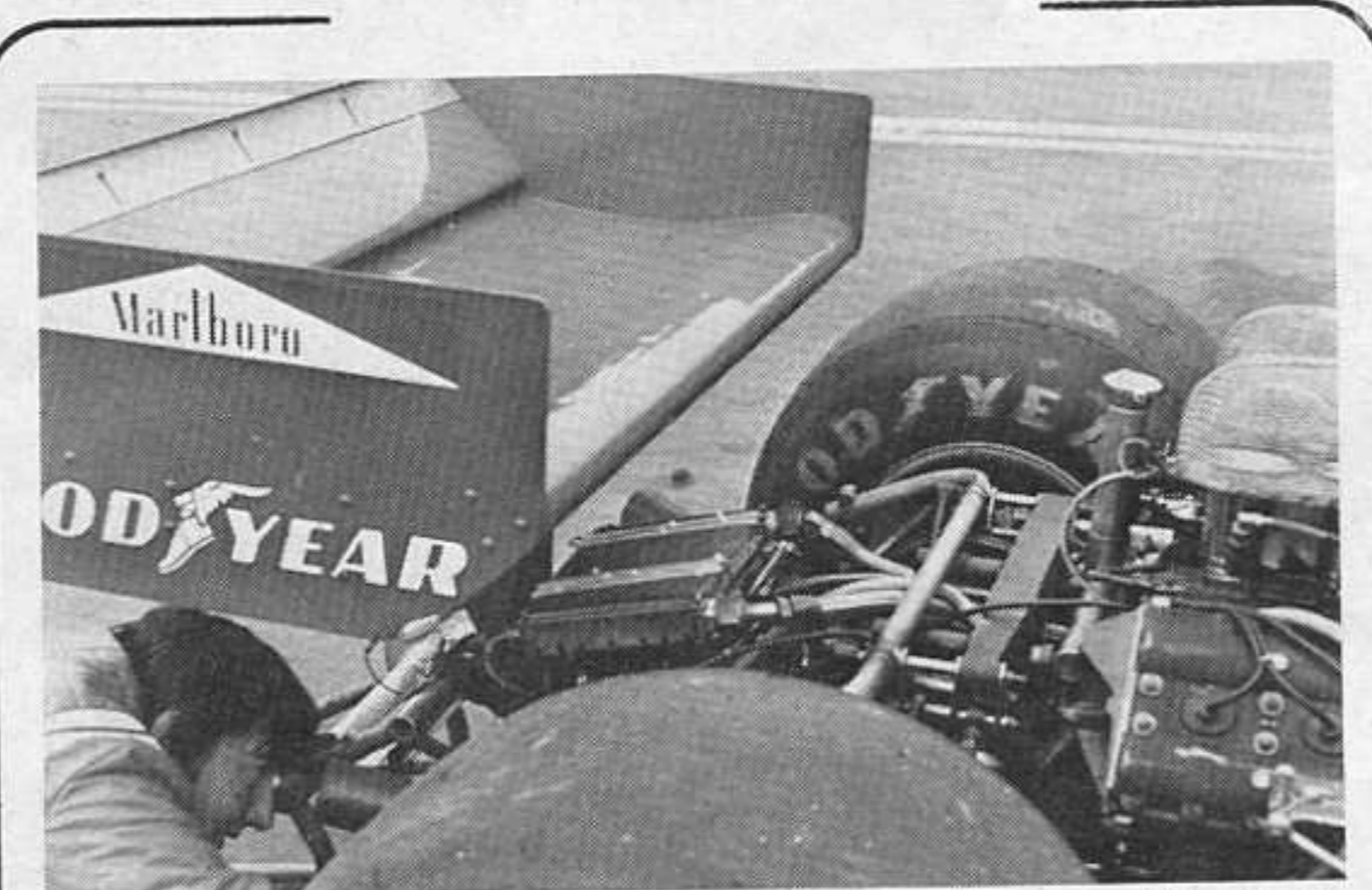
Sopra, sulla March di Merzario il radiatore olio della trasmissione è posto sopra al cambio. Sotto, il corto braccetto superiore della sospensione dietro della Tyrrell e l'alettone provato da Peterson a Monaco
