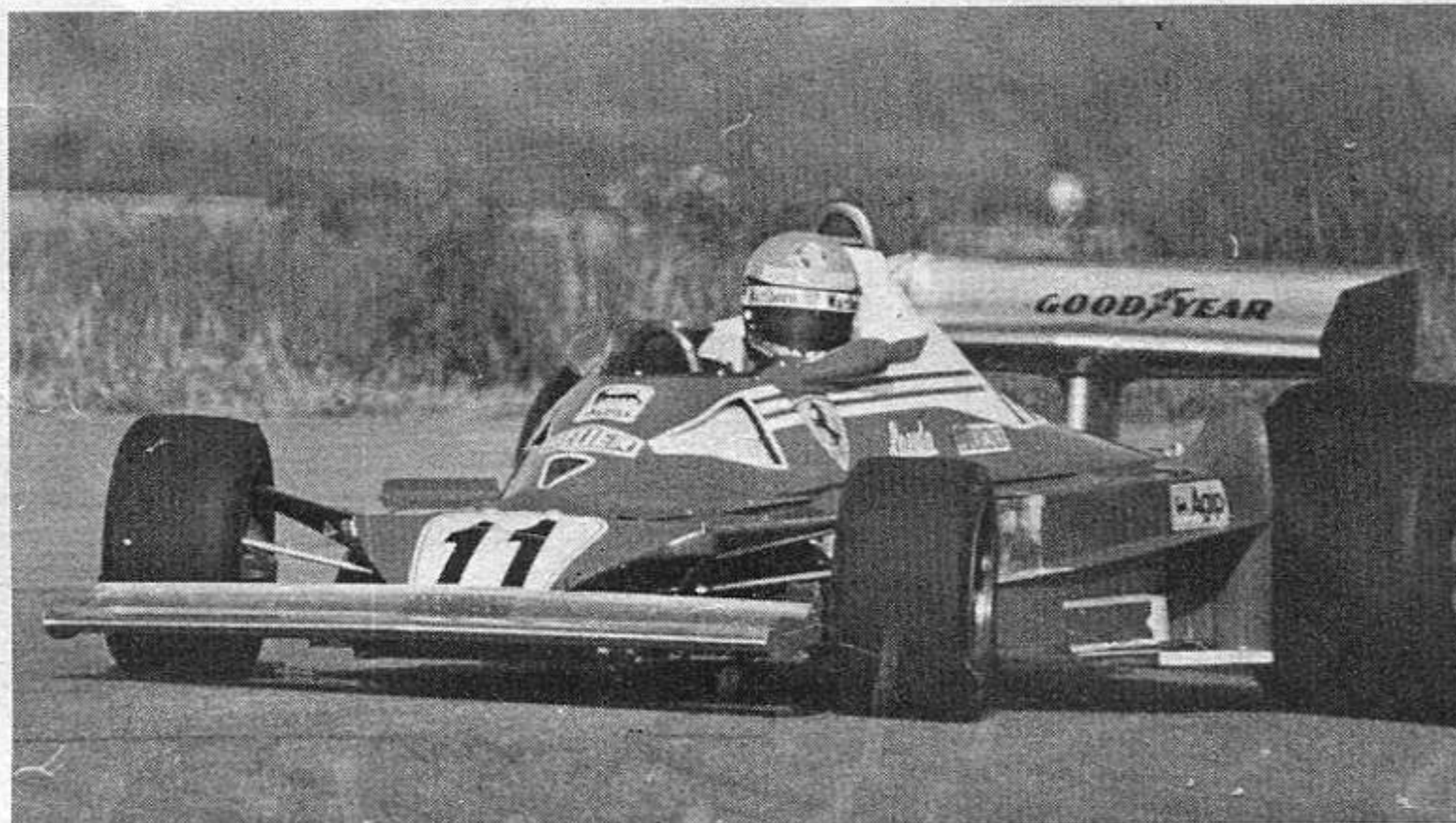
FIORANO - Niki Lauda impegnato sabato, al rientro dall'Inghilterra, nei collaudi di nuove sperimentazioni tecniche per Silverstone. Notare la protuberanza utilizzata per evacuare l'aria dal radiatore anteriore e lo spoiler
